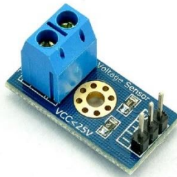
Gambar 2.9 Sensor Tegangan F031-06
