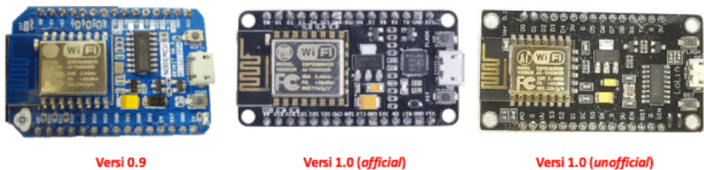
Gambar 2.21 NodeMCU ESP8266 Dalam Beberapa Versi [25]
