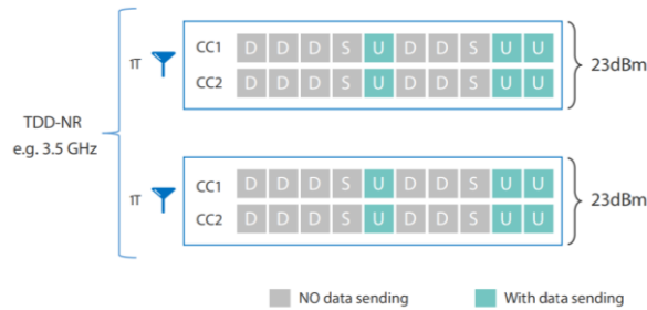
Gambar 2.15 Mode operasi uplink 5G Rel-15 UE dengan UL CA.
