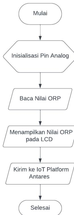
**Gambar 3.3** *Flowchart* Perancangan Perangkat Lunak (*Software*)
