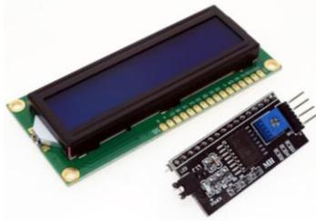
**Gambar 2.11 LCD dan modul I2C [34]**
