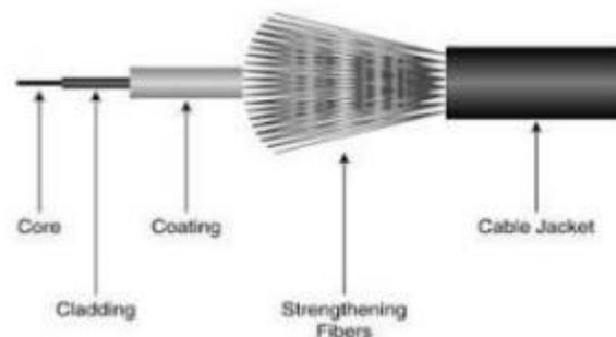
Gambar 2.2 Bagian-bagian kabel serat optik [6].
