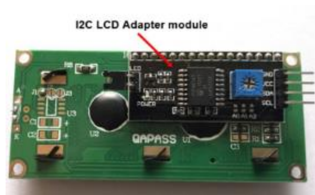
Gambar 2. 14 Modul I2C pada LCD 16x2
