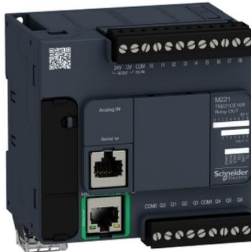
Gambar 2.7 PLC Schneider TM221CE16R [23]
