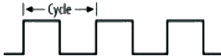
Gambar 2.20 PWM dengan Duty Cycle 50% [29]
