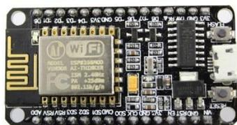
Gambar 2. 1 NodeMCU[9]
