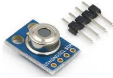
Gambar 2.7 Sensor suhu inframerah Modul GY-906 [14].
