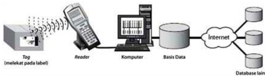
Gambar 2.2 Cara Kerja Sistem RFID
