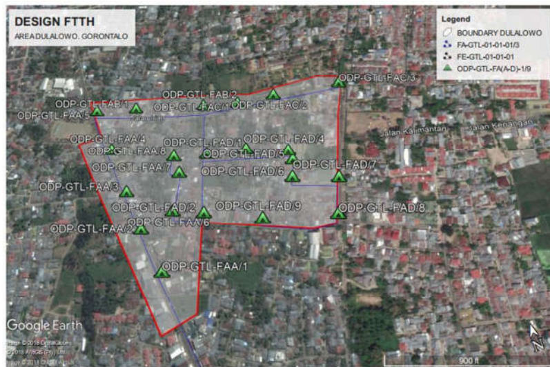
Gambar 3.6 Perancangan FTTH Lokasi Daerah Dulalowo, Prov. Gorontalo
