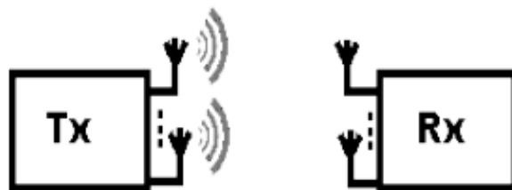
Gambar 2.5 MIMO pada Teknologi LTE[4]
