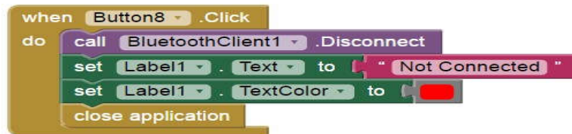
Gambar 3.22 puzzle block untuk button disconnect dan menutup aplikasi
