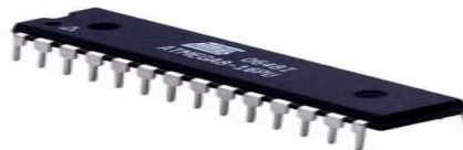
Gambar 2.2. Bentuk fisik ATmega 8
