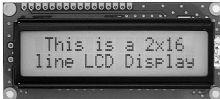
Gambar 2.10. Bentuk Fisik LCD 16x2
