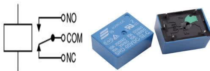
Gambar 2.4 Susunan Relay Sederhana dan Bentuk Fisik Relay [5]
