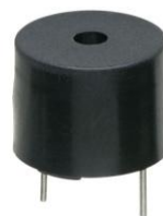
Gambar 2.10. Hardware dari komponen buzzer . [11]
