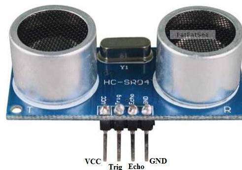
Gambar 2.3. Hardware dari sensor jarak ultrasonik HC-SR04.[4]
