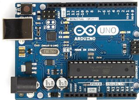
Gambar 2.6. Hardware Arduino UNO R3.[7]
