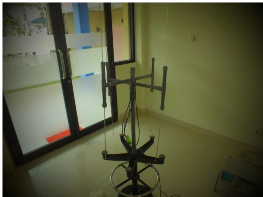
Gambar 3.4 Hasil pembuatan antena omnidirectional secara doppler
