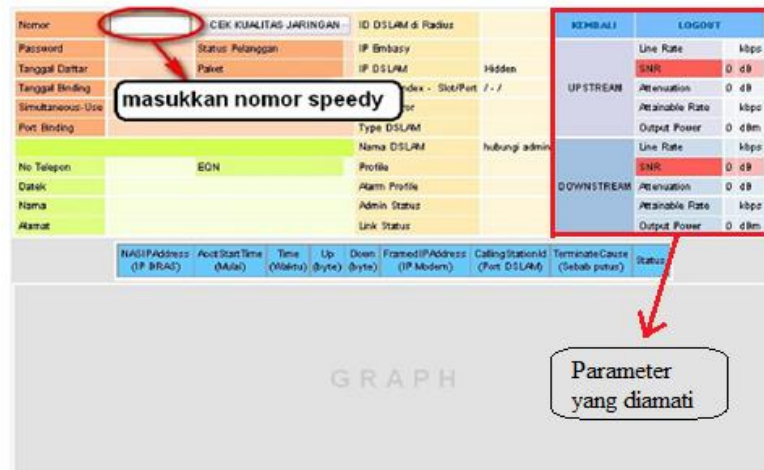
Gambar 3.7 Tampilan nilai SNR, attenuation , dan attainable rate pada software Embassy
